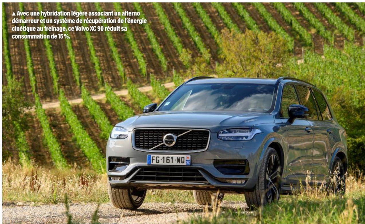
▲ Avec une hybridation légère associant un alterno-démarrateur et un système de récupération de l'énergie cinétique au freinage, ce Volvo XC 90 réduit sa consommation de 15 %.
